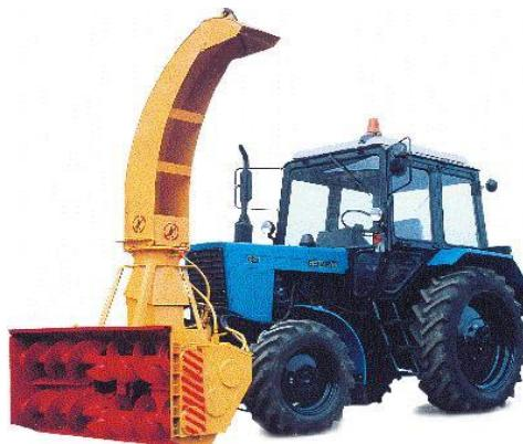
*Предназначен для очистки дорожных покрытий от снега, а также для удаления снежных валов, образованных другими снегоочистителями, путём отбрасывания в сторону или погрузки в транспортное средство.*
